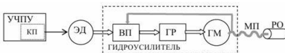
Рис. 5. Функциональная схема электрогидропривода
