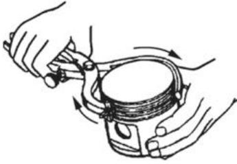
Перед установкой поршневых колец надо тщательно прочистить его канавки от нагара с использованием специального приспособления.
